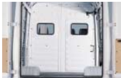
Durchgehende Trennwand mit Fenstern
