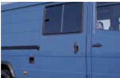
Laderaum-Schiebetür mit Fenster
